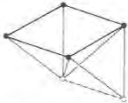
9 Módulo formado por un semi-octaedro y un tetraedro
