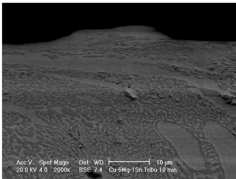
Figura 4.25 Flujo de material en una zona distinta.
