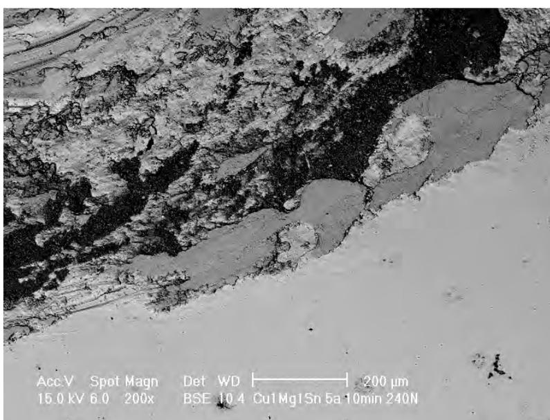
**Figura 4.7 Frontera entre el material de origen y la zona con polvo abrasivo acumulado.**
