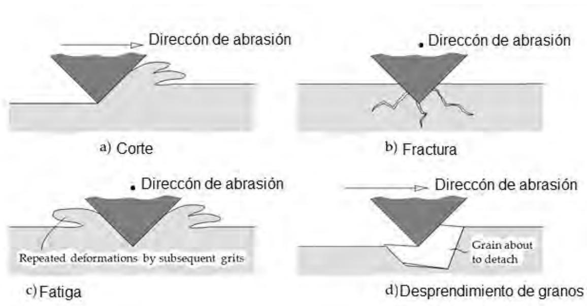
**Figura 2.1 Los mecanismos de desgaste por abrasión: microcorte, fractura, fatiga y retirada de grano [8].**
