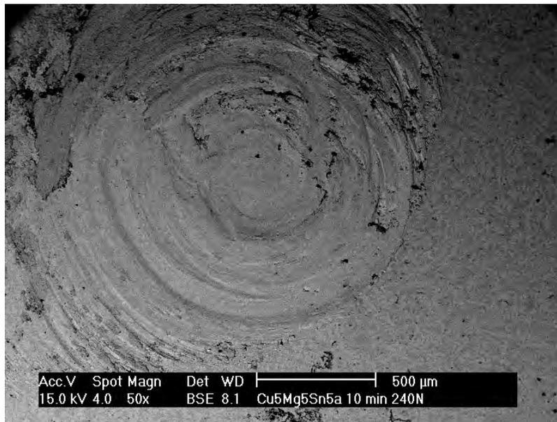
**Figura 4.32 Superficie del material Cu-5Mg-5Sn ensayado tribológicamente durante 10 minutos.**
