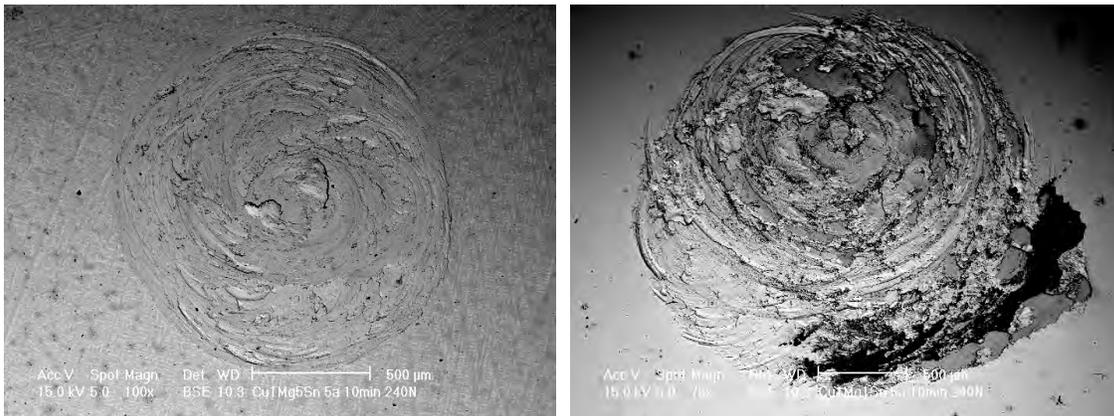
**Figura 5.1** Diferentes acabados después del ensayo tribológico.
