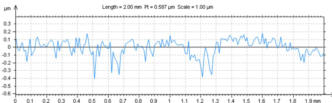
**Figura 4.1 Perfil de rugosidad de una probeta Cu-1%Mg-1%Sn. Mechanical 3D®.**
