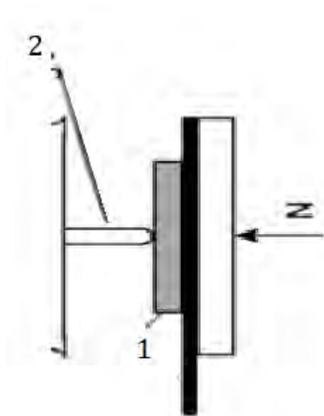
**Figura 2.5 Configuración del tribómetro coaxial. (1) Placa usada como muestra, (2) Perno de punta esférica y (N) fuerza normal aplicada sobre la muestra para lograr huella de desgaste.**
