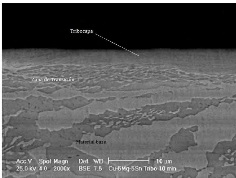
**Figura 4.35 Tribocapa y zonas de deformación plástica.**
