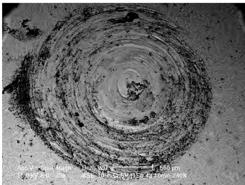
**Figura 4.19 Superficie de un material Cu-5Mg-1Sn (10 minutos).**
