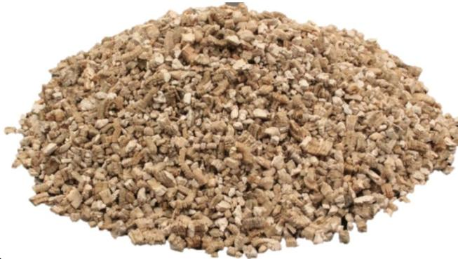
Figura 7. Vermiculita de partículas medianas (mayores de 5 mm).
