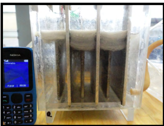
Figura 4.22. Remoción final de una concentración inicial de 1 mg/L de \text{Cu}^{2+} con 2A.
