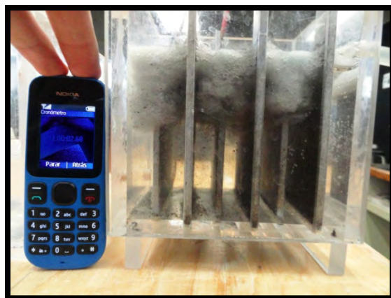
Figura 4.25. Remoción final de una concentración inicial de 10 mg/L de \text{Cu}^{2+} con 1A.
