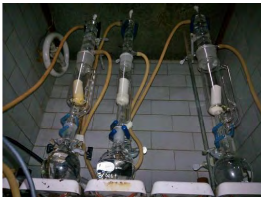
Figura A.2.15. Cuantificación de grasa mediante el método de Soxhlet
