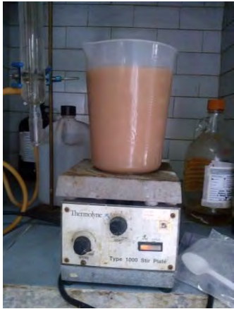
Figura A.2.7. Desmineralizado de las harinas con EDTA dibásico de sodio
