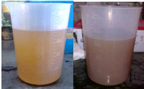
Figura 23. Aguas de lavado de harina desmineralizada con ácido acético al 8%(imagen izquierda) y con EDTA 1M (imagen derecha)
