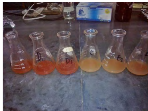
Figura A.2.18. Extracción de los pigmentos carotenoides (astaxantinas) mediante calentamiento a 80°C
