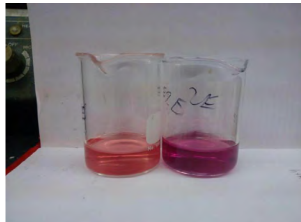
Figura A.2.12. Determinación de calcio mediante titulación con EDTA
