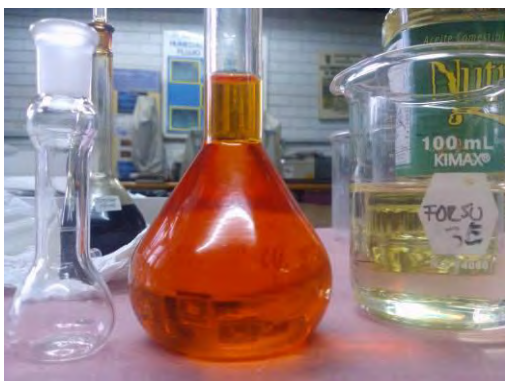
Figura A.2.17. Elaboración de solución patrón de astaxantina para la curva estándar
