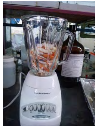
Figura A.2.4. Molienda de los restos de jaiba secos
