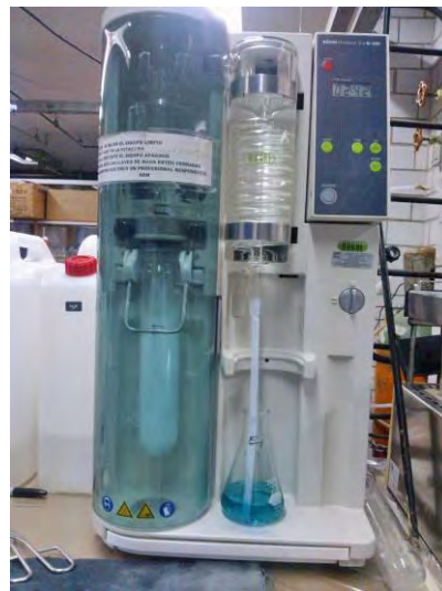
Figura A.2.14. Determinación de proteína por el método de Kjeldahl
