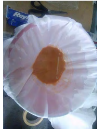
Figura A.2.8. Filtrado de la harina desmineralizada empleando tela de poro pequeño y que no suelta pelusa
