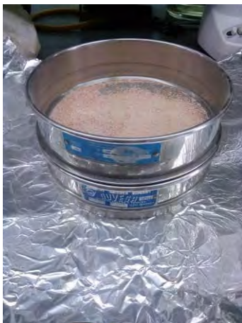
Figura A.2.5. Tamizado de las harinas de jaiba malla 40 y 80 ( 420\mu\text{m} y 177\mu\text{m} respectivamente)
