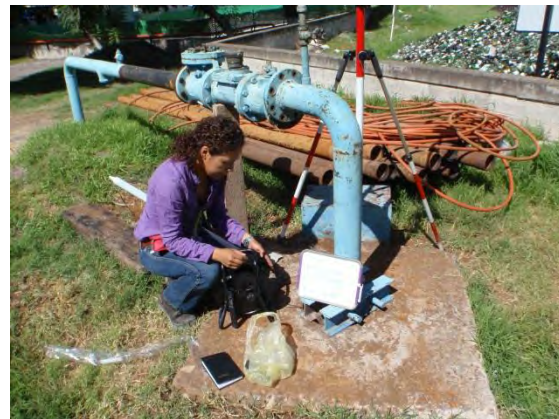
Figura 29. Medición de niveles estático en los pozos de monitoreo.
