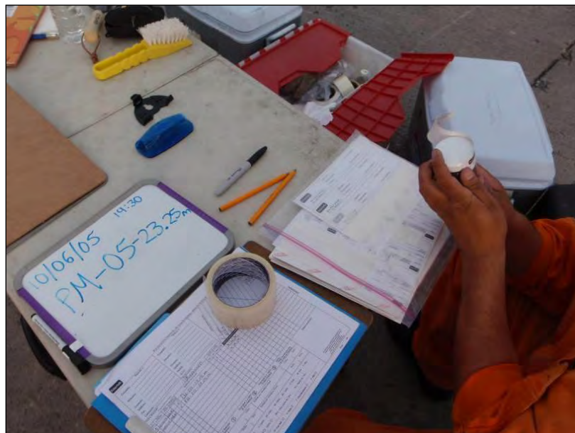
Figura 19. Toma, envasado y etiquetado de muestras de suelo.
