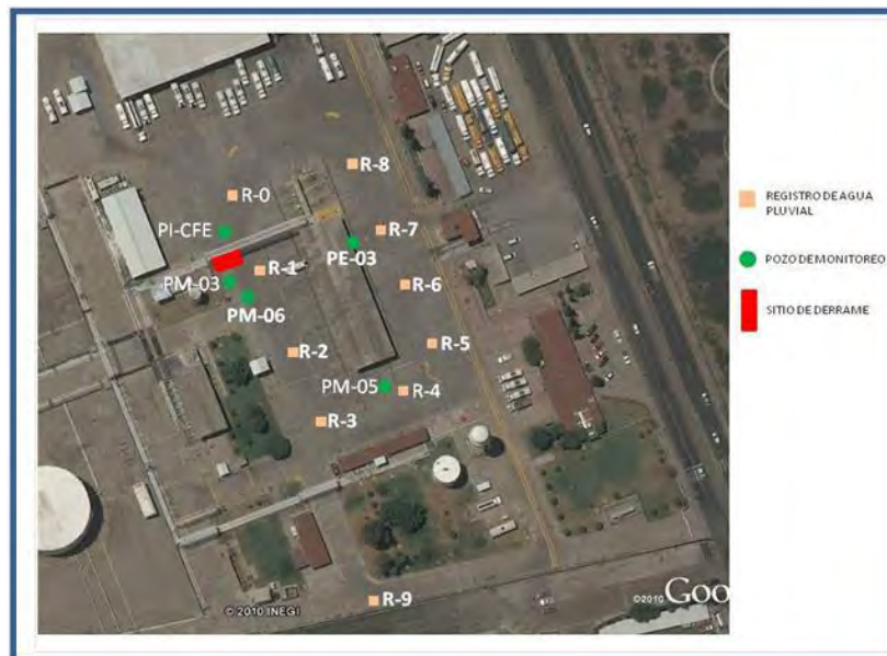
Figura 34. Registros pluviales y pozos que se monitorearon durante la realización de la prueba.
