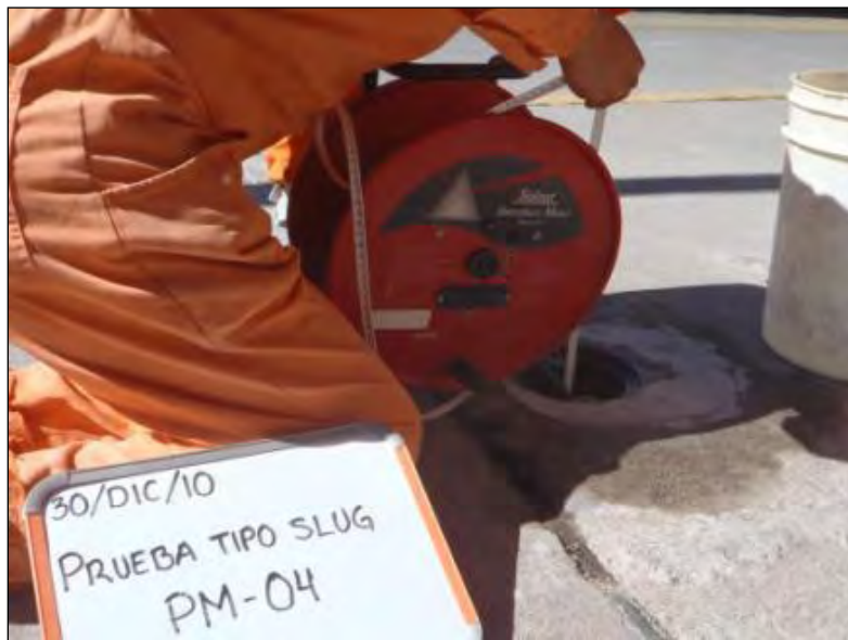
Figura 31. Realización de prueba tipo slug denominada de perturbación instantánea del nivel de agua en los pozos.
