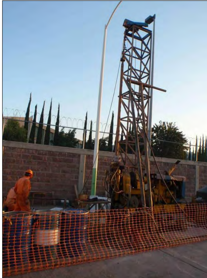
Figura 17. Equipo de perforación de barrenación a diamante para el muestreo de suelos.
