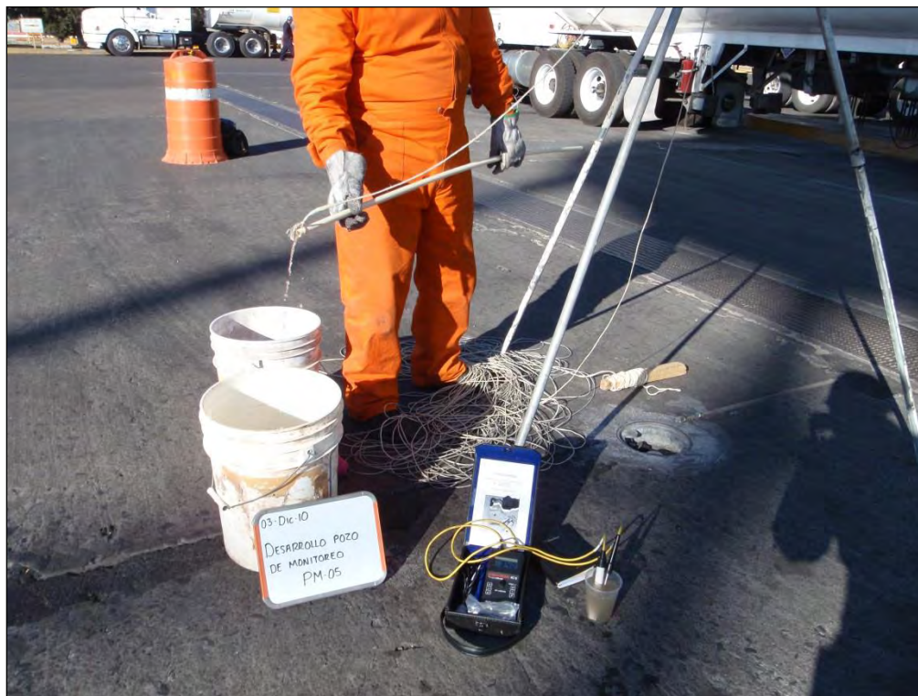
Figura 26. Extracción de agua de pozos de monitoreo.
