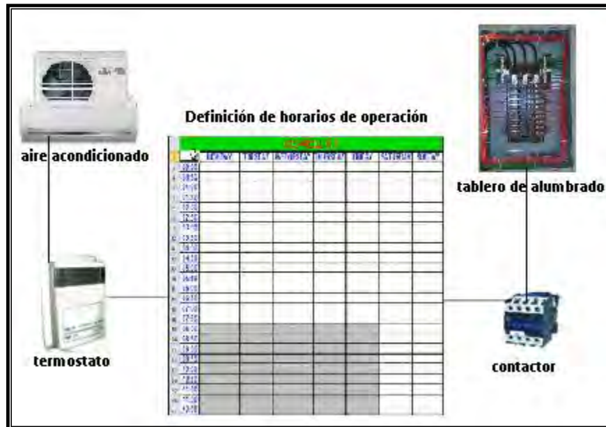
Figura 1.6. Configuración de sistemas de Administración de Energía SAE.
