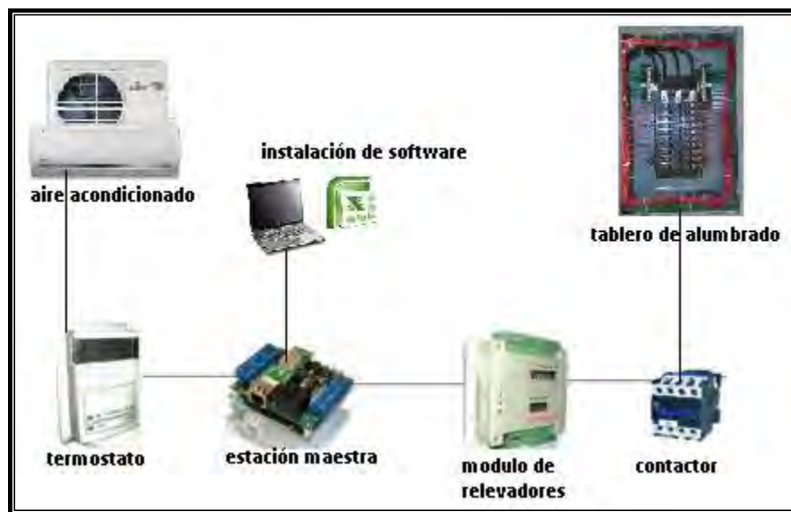
Figura 1.5. Configuración del Sistema de Administración de Energía.
