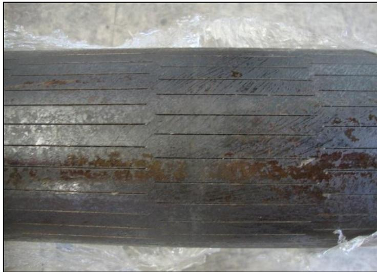
**Figura 6.3** Tubería ranurada (Arteaga M., 2011)
