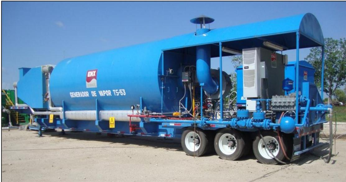
**Figura 6.7** Generador de Vapor
