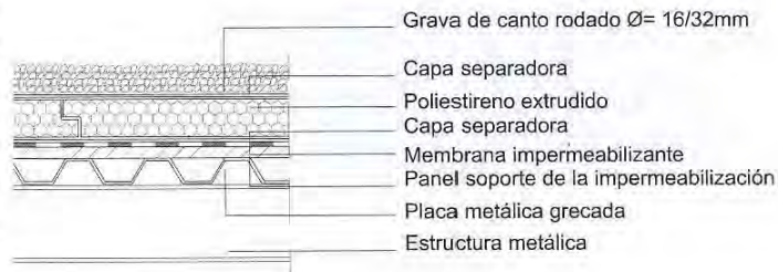
Figura 3. Estructura resistente discontinua para cubierta invertida
