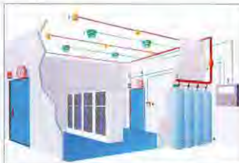
1. Detector, 2. Central de detección y control, 3. Alarma óptica, 4. Alarma acústica, 5. Colector actuador eléctrico, 6. Botellas con control de flujo, 7. Tubería de distribución, 8. Boquilla, 9. Pulsador de bloqueo-depuro.
