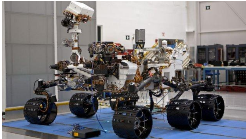
Figura 1-6. El robot Curiosity diseñado para explorar la superficie de Marte es un ejemplo de un robot móvil
