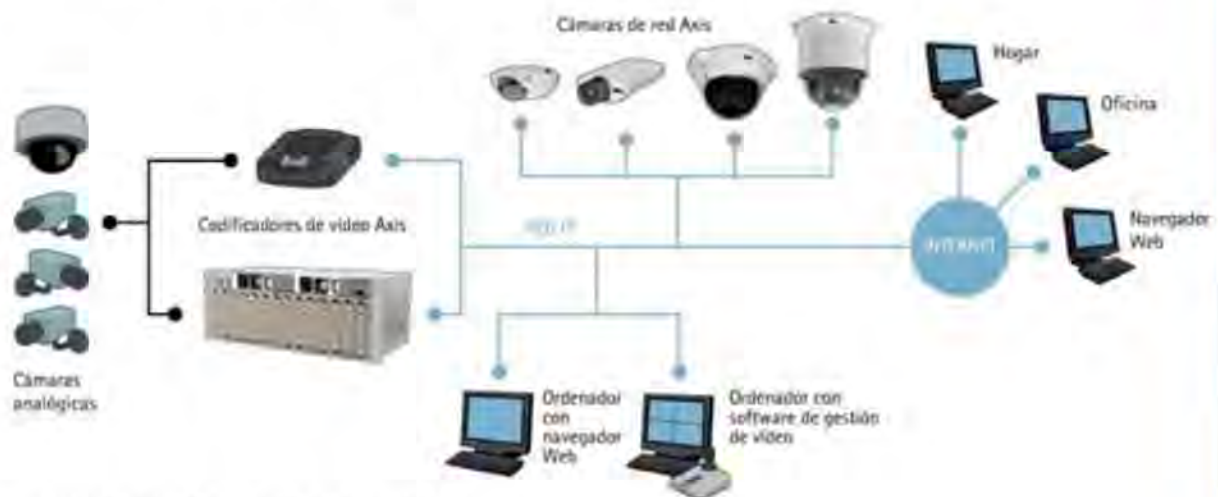
DIAGRAMA D ECÓMO FUNCIONA EL CCTV
