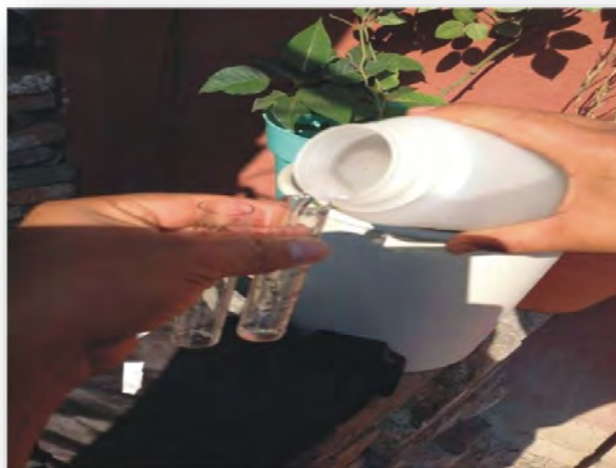
Figura 2.5. Análisis del contenido de cloro in situ .
