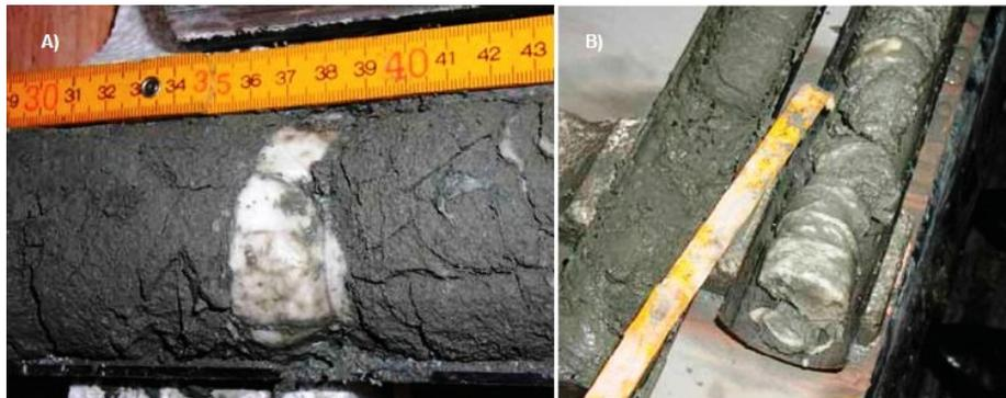
Figura 14. Núcleos con de hidratos de metano masivos (Fujii et al, 2009).
