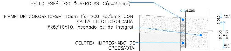
DETALLE D/2 Detalle muro milán y banquete SECCIÓN esc.: 1/5
