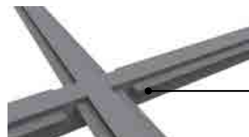
Perfiles en "L" internos que soportan el piso
