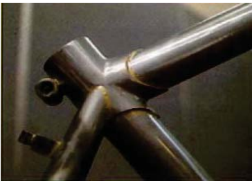
Fundición de racores. Entre racores de cromo y tubos de acero se consiguen uniones limpias utilizando soldadura de latón.
