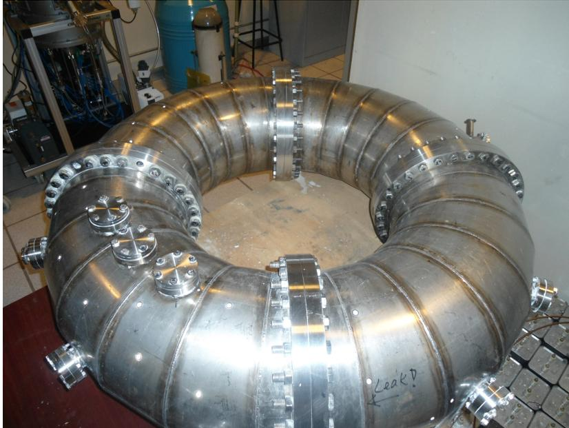
**Figura 1.16:** Cámara de vacío del TPM-1
