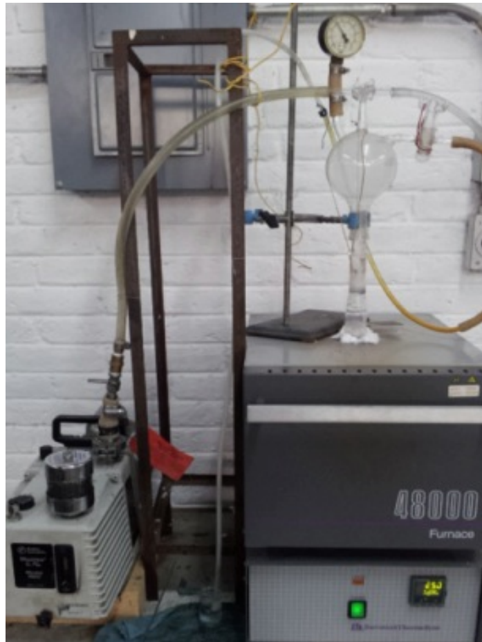
Figura 27.- Dispositivo sinter II , el cual cuenta con un sistema de vacío, válvulas y manovacuómetro.
