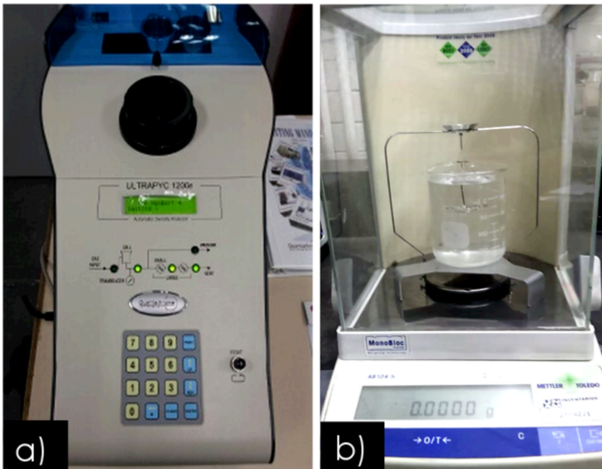
Figura 28.- a) Picnómetro y b) balanza de densidades, empleados para medir la densidad experimental.
