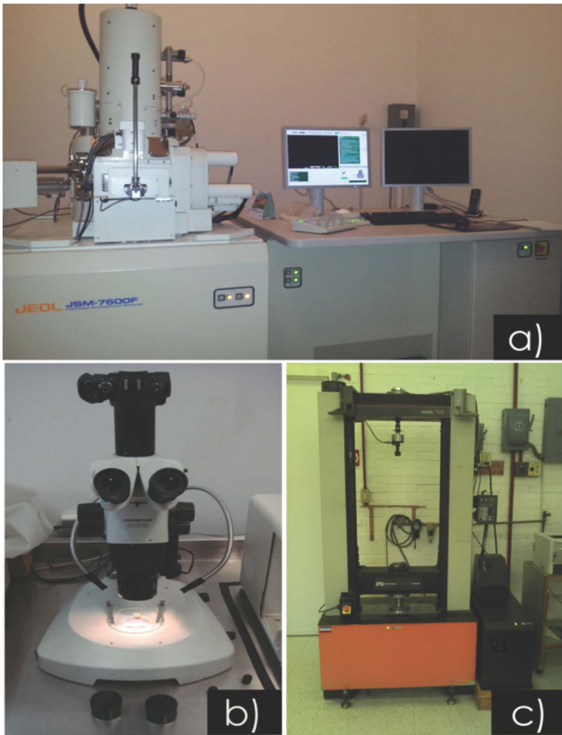
Figura 29.- a) Microscopio Electrónico de Barrido con Emisión de Campo (Jeol JSM 7600F), b) microscopio estereoscópico (marca OLYMPUS modelo SZX16) c) máquina de ensayos universales Instron 1125-5500R.
