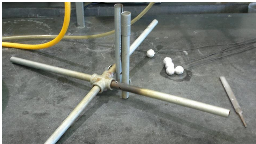
Figura 2.1.9.- Dispositivo para sostener los termopares en el baño de aluminio puro.
