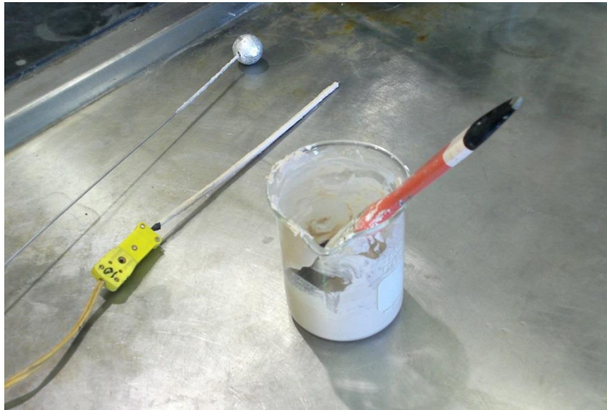
Figura 2.1.8.- Pintura de zirconio y termopares pintados con la misma.
