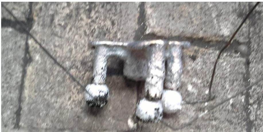
Figura 2.1.6.- Esferas de aluminio puro con sistema de colada obtenidas tras vaciar en el molde aluminio puro.
