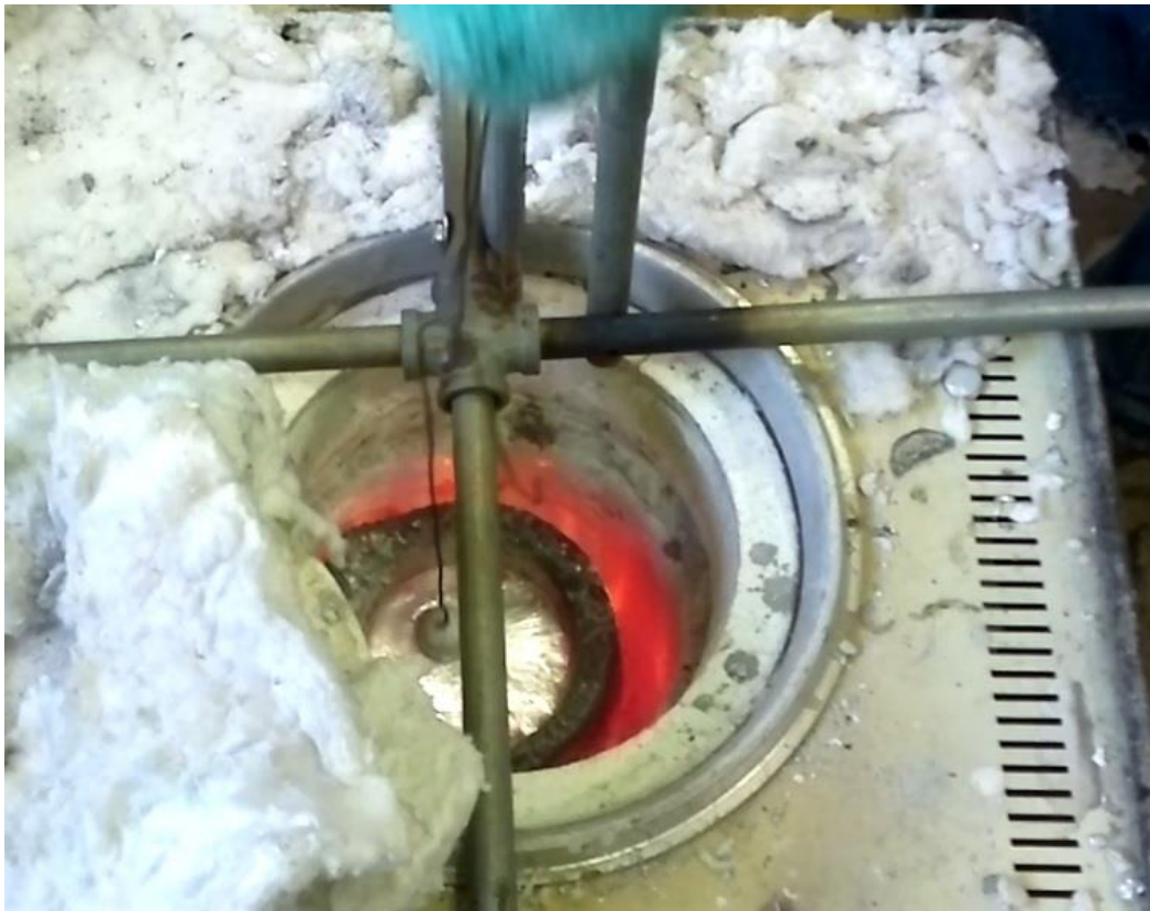
Figura 2.1.10.- Sujeción de esferas en el baño de metal líquido con ayuda del dispositivo de la Figura 2.1.9 para pruebas de cambio en radio con el tiempo.
