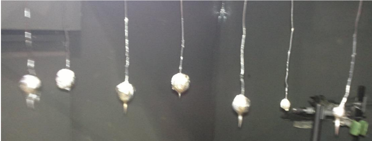
Figura 2.1.11.- Ejemplo de serie de esferas obtenidas durante la experimentación de cambio de radio en función del tiempo durante la fusión de aluminio en baños del mismo material.
