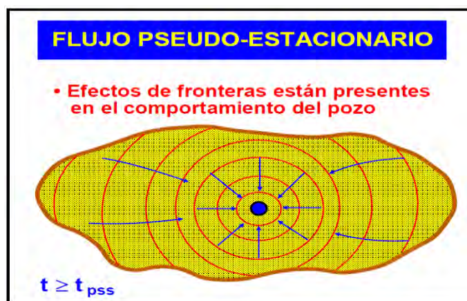
Figura I. 14 La caída de presión en la frontera (tomada de las notas del Dr. Heber Cinco Ley).
