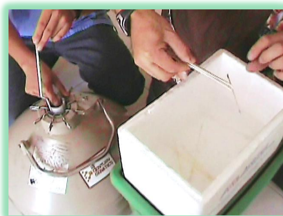
Fotografía 6. Extracción de las pajillas inmersas en nitrógeno líquido para su posterior almacenamiento en el tanque de transporte.
