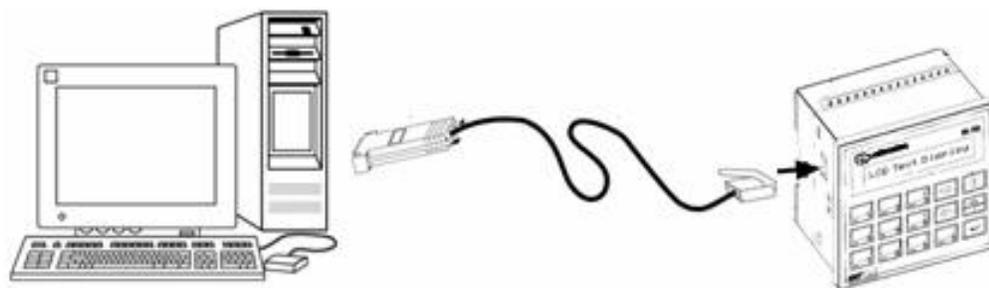
Cable convertidor Serial a USB.
