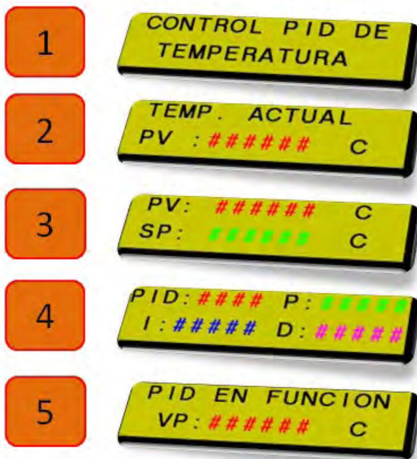
Figura 4.25: Displays que fueron creados en la programación del U90Ladder para que aparecieran en la pantalla del PLC.
