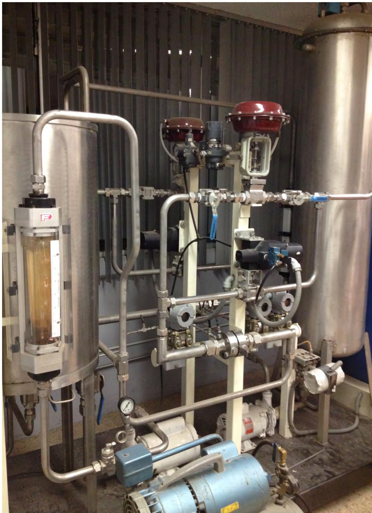
Figura 3.2: Foto de planta piloto. A la izquierda, el depósito de carga abierto; a la derecha, el depósito de carga cerrado; al centro, la instrumentación: válvulas, bombas, transmisores y tubería; y en la parte inferior, se encuentra el compresor para alimentar las válvulas. **Foto en Laboratorio de Control y Robótica cortesía de la Facultad de Ingeniería, UNAM.**
