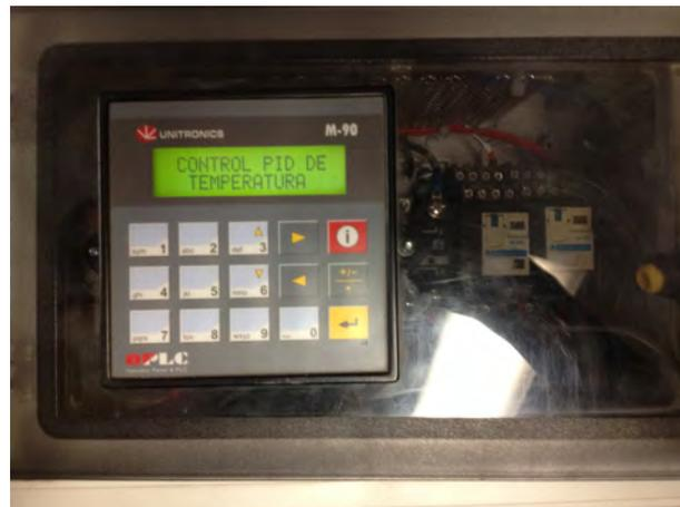
Figura 4.24: Foto PLC con primer display.
