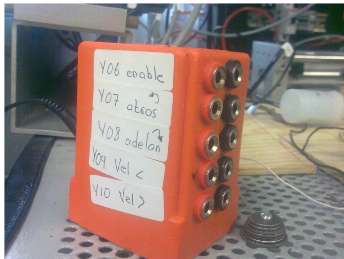
Figura Anexo 11: Módulo Control de Velocidad.
