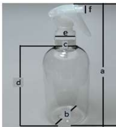
Figura 9. Frasco de polietileno de alta densidad, donde se marca el área que fue seleccionada para la prueba de dimensiones.
