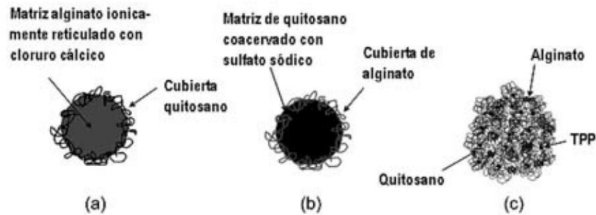
Figura 13. Representación esquemática de tres distintos tipos de nanopartículas a base de quitosán y alginato: a) Nanomatriz pre-gelificada de alginato por reticulación ionotrópica con cloruro cálcico recubierta con quitosán; b) Nanomatriz de quitosán preparada por coacervación con sulfato de sodio recubierta con alginato; c) Nanomatriz híbrida co-gelificada por gelificación ionotrópica de quitosán con tripolifosfato pentasódico (TPP) y complejación concomitante del alginato 69 .
