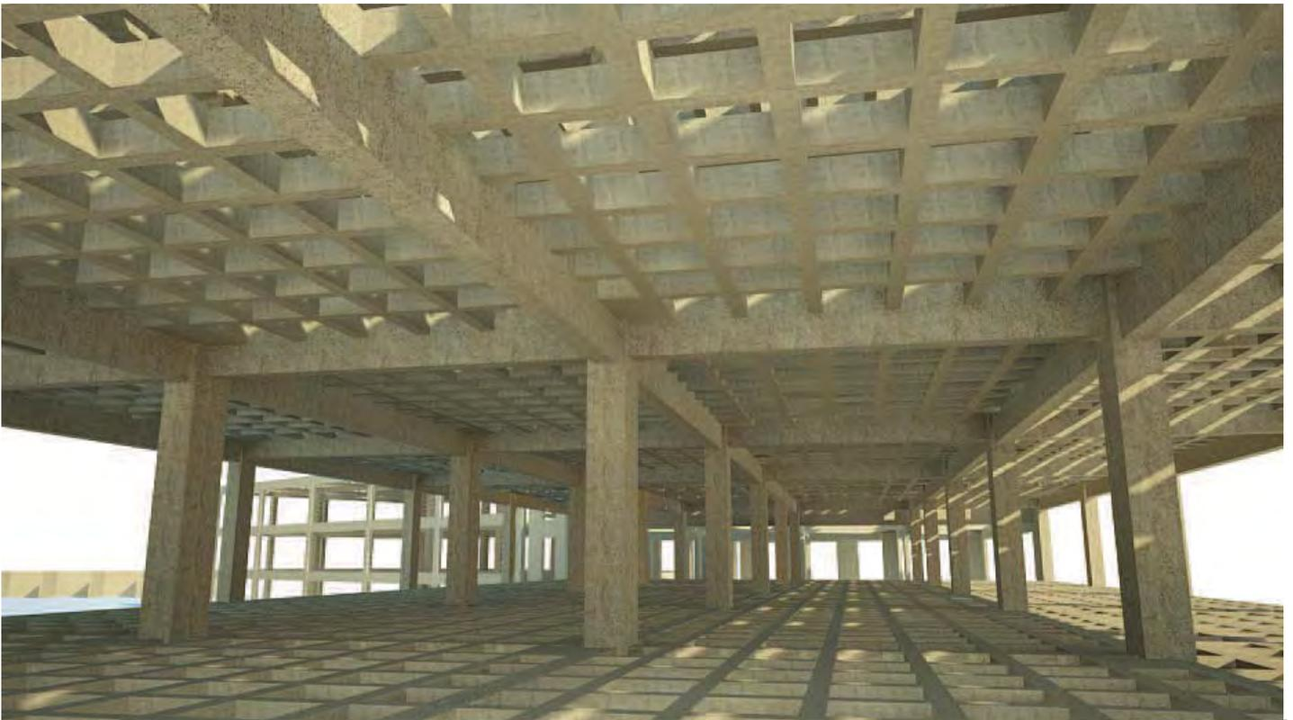
Marcos de concreto armado y nervaduras en ambos sentidos, el concreto cuenta con agregado café.
