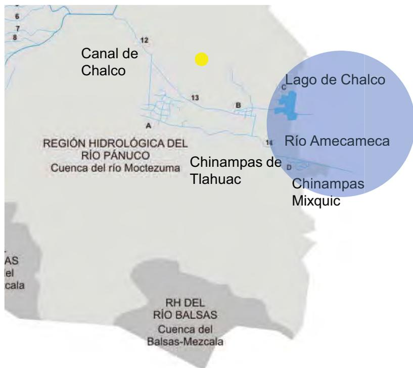
El sistema de canales de la chinampera es alimentado con aguas residuales procedente de la planta de tratamiento del cerro de la Estrella. De no ser así, los canales estarían secos debido a que los manantiales que alimentaban los lagos de la cuenca están exhaustos o han sido desviados hacia el desagüe general del valle de México.
