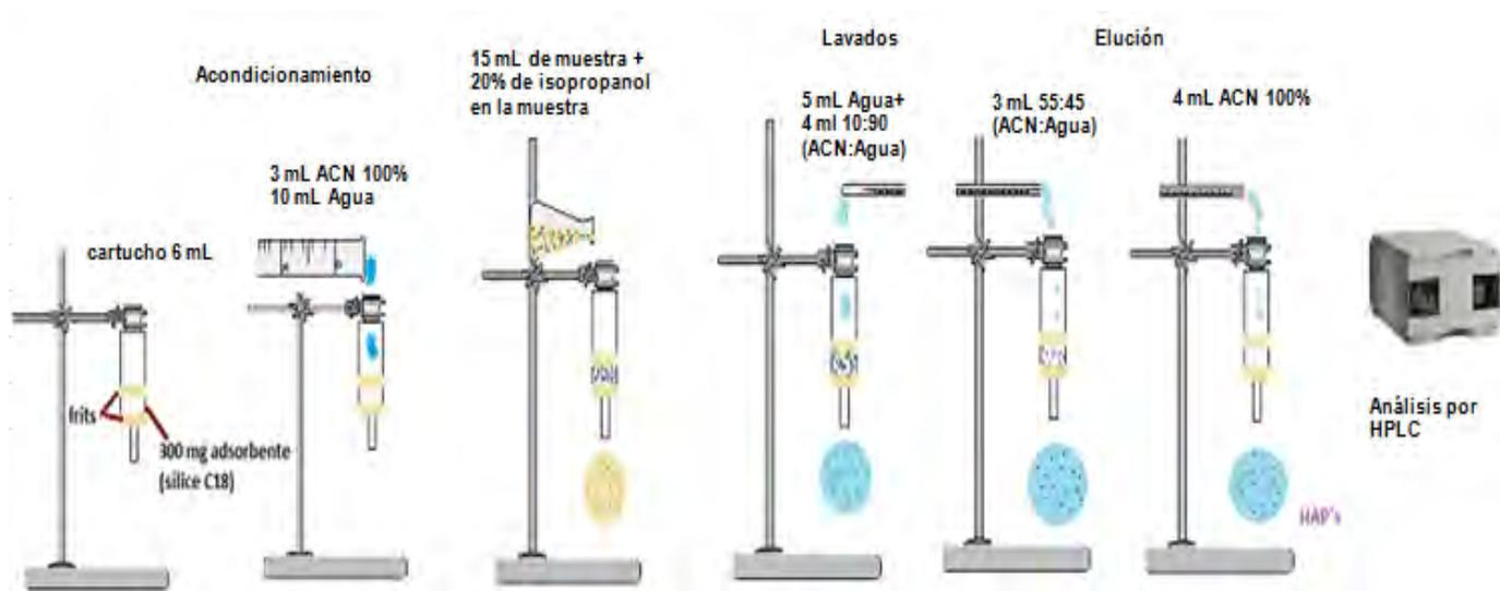
Figura 2.2.3.2.1. Procedimiento de Extracción en Fase Sólida.
