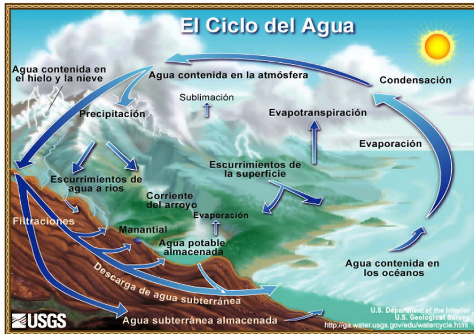
Figura 2.4 El ciclo del Agua, Fuente: U.S. Department of the interior. U.S. Geological Server
