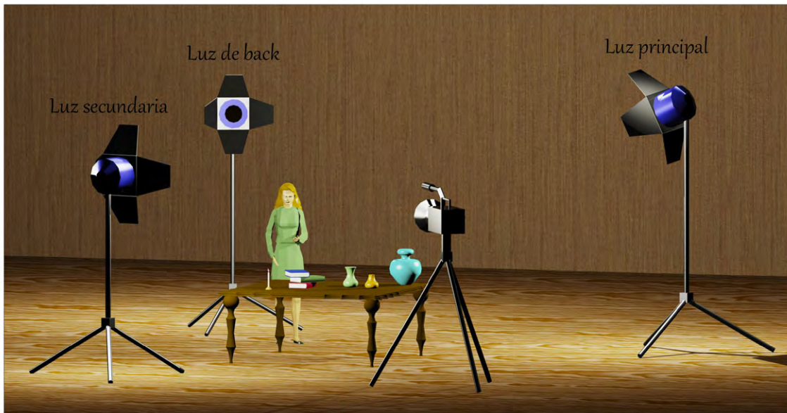
FIG. IV.8. Ejemplo de un diseño de iluminación con tres fuentes luminosas. © Anabel Sánchez Morales.
