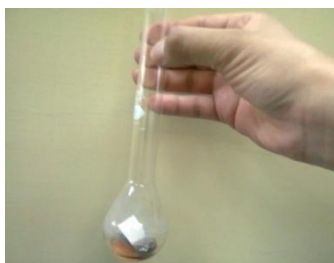
Figura 8. Matraz con reactivos Kjeldahl
