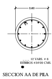
SECCION AA DE PILA
