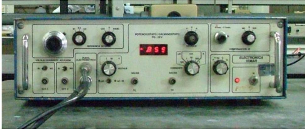
**Figura (2.3.1): Potenciostato/ Galvanostático VIMAR**
