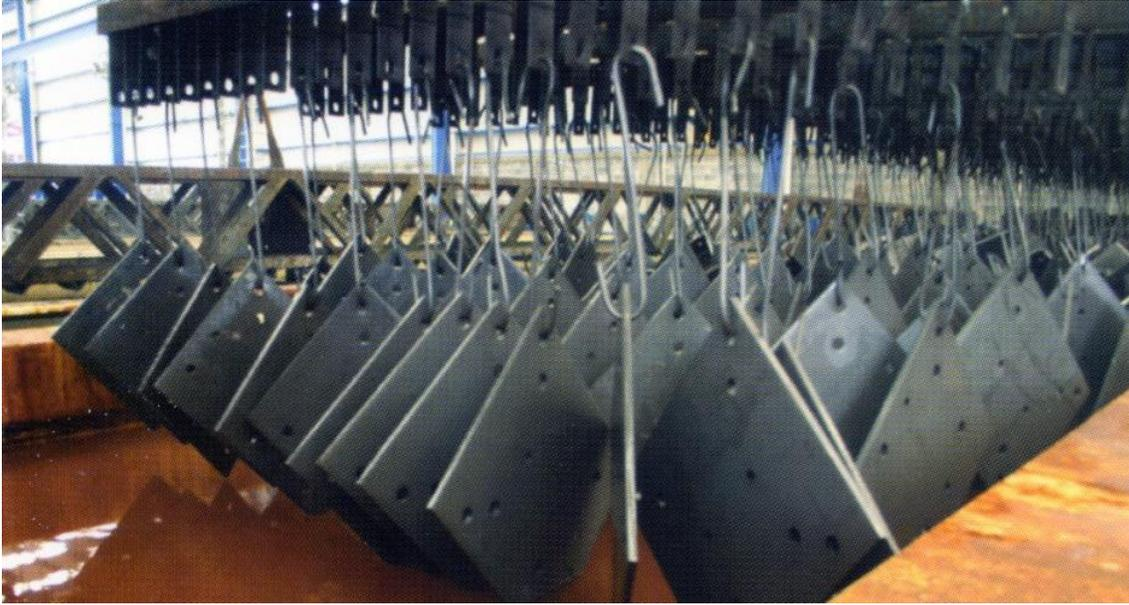
**Figura (1.9.1.1) Preparación de la superficie del acero a galvanizar.**
