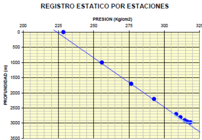
Figura 3.24: Comportamiento de la presión con respecto a la profundidad para gas y condensado. 8
