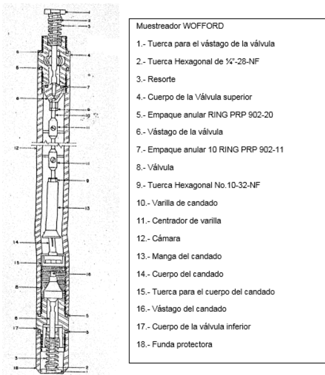
Figura 3.1: Corte de muestreador de tipo circulación. 30
