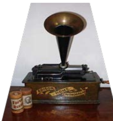
Ilustración 8.4.- Fonógrafo y cilindros de cera.
