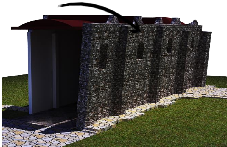
Figura 3.8 Falta de verticalidad de muros por empuje de cubierta (Rivera, 1997)
