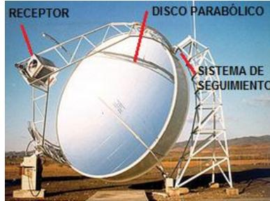
Figura 1. 14 Sistema de Disco Parabólico.
