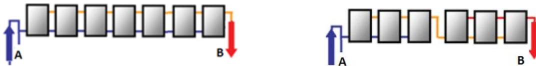
**Figura 4. 3 Colectores por ramal, izq.) Paralelo, der.) Serie-Paralelo**
