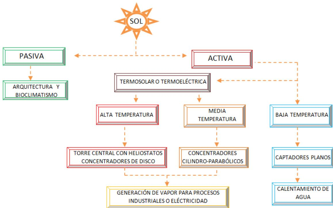
Figura 1. 8 Clasificación de la energía solar - térmica.
