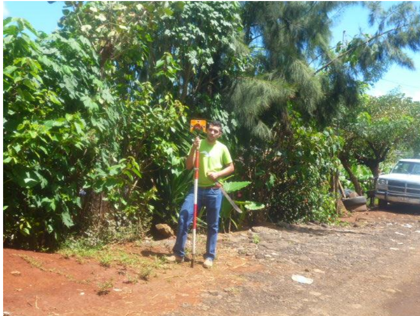
Figura 4.22. Nivelación de la baliza con el prisma
