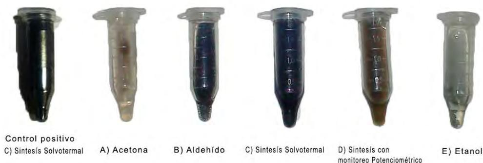
**Figura 10** Prueba cualitativa de Tollens para una A) Acetona (control negativo), B) aldehído (control positivo), C) aguas madres de las síntesis solvotermal D) aguas madres de las síntesis con seguimiento potenciométrico y E) etanol matriz.
