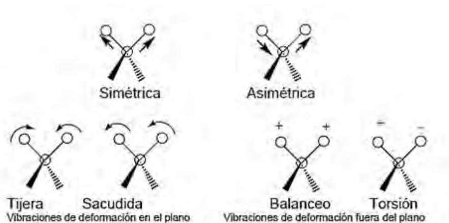
**Figura 4** Vibraciones de estiramiento simétrica, asimétrica, de flexión en el plano y fuera del plano. Nota: + y – se refieren a vibraciones perpendiculares al plano del papel
