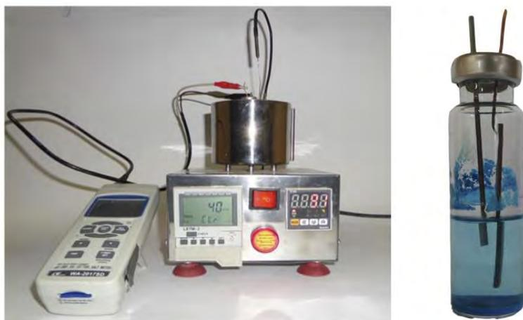
**Figura 5** Sistema para el seguimiento del pH durante el proceso de reacción del CUBTC a 130 °C, 18 horas.
