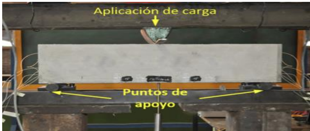
Figura 59. Aplicación de carga en la prueba de flexión de la viga instrumentada con una FBG
