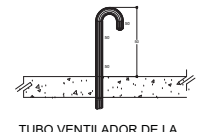
TUBO VENTILADOR DE LA RED DE SANITARIOS
