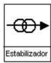
Fig. 1.9 Estabilizador de tensión.
