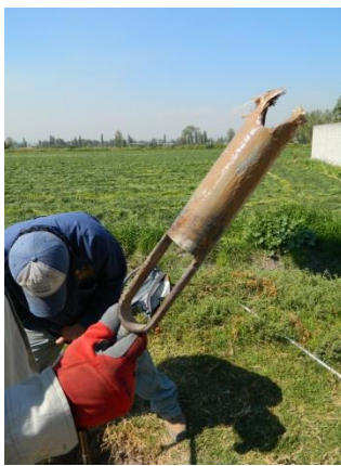
Figura 24. Muestreo con perforadora manual.
