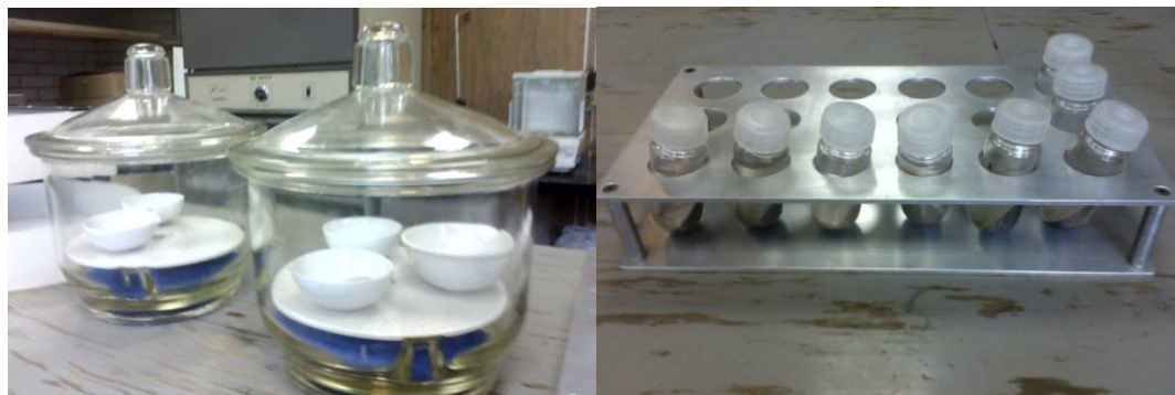
Figura (ii) Fotografías de las muestras en proceso de desecación después de la remoción de materia orgánica (izquierda) y del centrifugado, después de la remoción de materia orgánica en el enjuague del NaCl (derecha).
