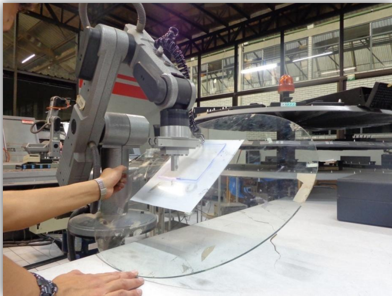
Imagen 3.2.9 Robot Scorbot-ER VII, dibujo en el Plano XY con rotación en el eje X de 45°.
