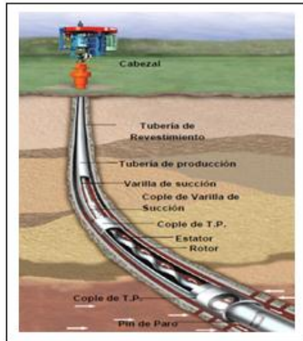
Figura 1.9 Configuración de las principales partes de un BCP 4
