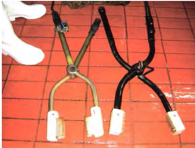
Fig. 18 Pinza eléctrica de aturdimiento para cerdo. Manual de Bienestar Animal para Operarios de Matanza en Rastros. SAGARPA (2013).
