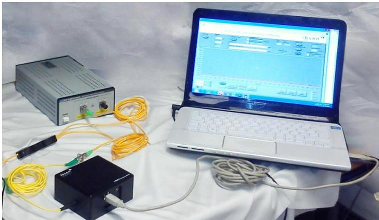
**Figura 5.5** Arreglo de conexiones para el monitoreo de la FBG (fotografía).
