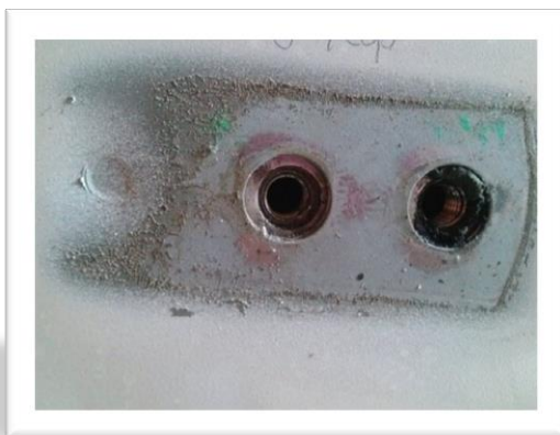
Fig. 7.5 Posición de la bisagra en la carrocería
