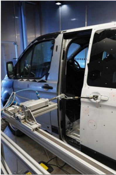
Fig. 4.1 Prueba de impacto en puertas deslizantes de Ford Transit Custom Van 1
