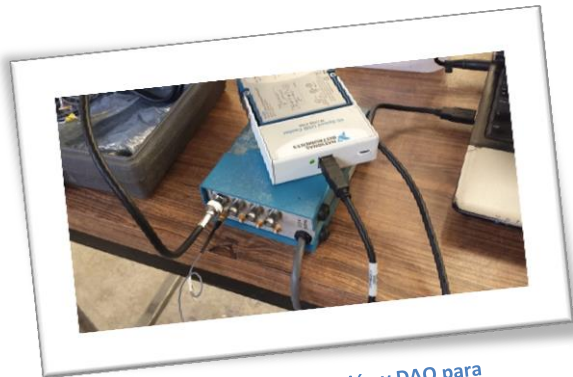
Fig. 7.31 Fuente de alimentación y DAQ para adquisición de señales
