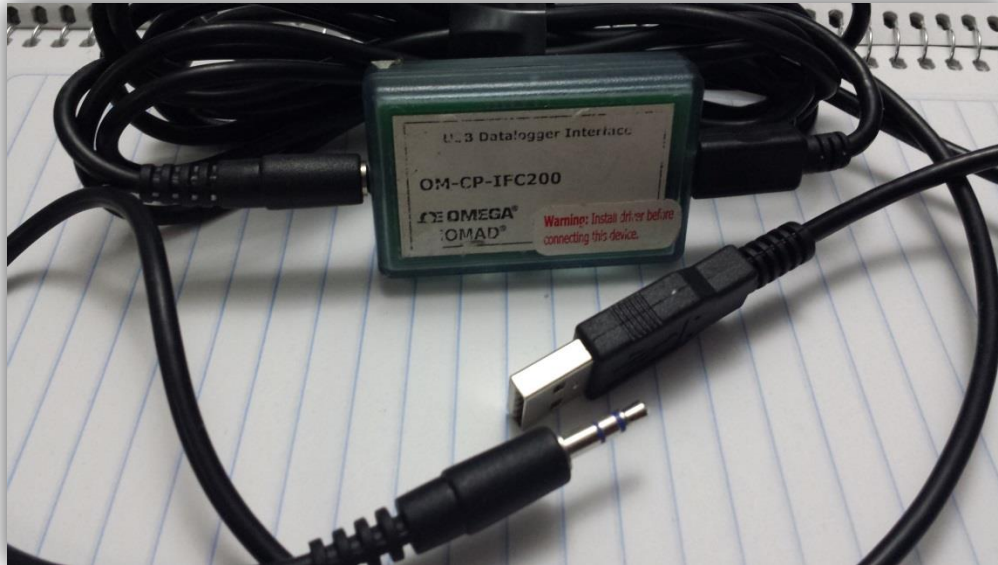
Fig. 7.15 Conexión correcta del cable de adquisición
