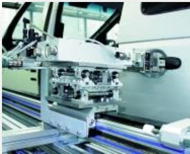
Figura 5.1 Equipos de prueba utilizados por DaimlerChrysler para la prueba de resistencia a largo plazo de las puertas del vehículo
