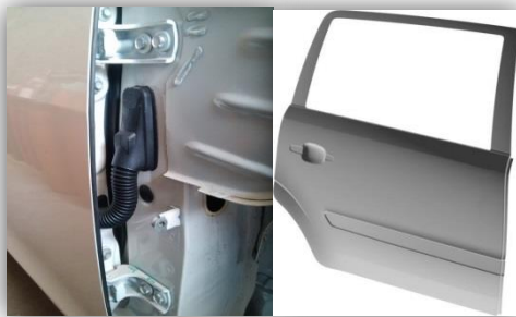
Fig. 6.3 Ejemplo de puerta convencional con eje de bisagras al frente y ejemplo de eje de rotación
