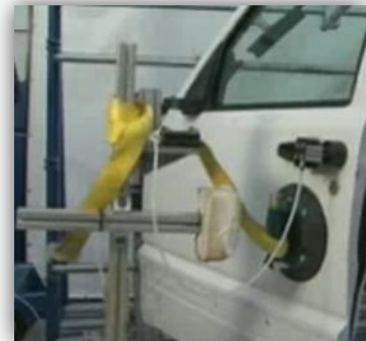
Fig. 5.4 Sistema encargado de abrir y cerrar la puerta, empresa MGA Research
