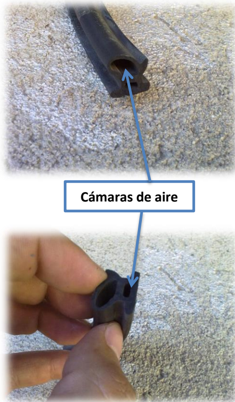
Fig. 6.10 Corte transversal del empaque de neopreno
