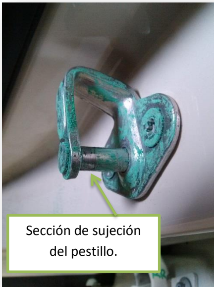
Fig. 7.10 Rastro de pintura sobre el aro metálico
