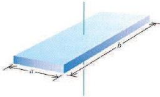
Fig. 7.39 Diagrama del momento de inercia de un prisma rectangular sólido
