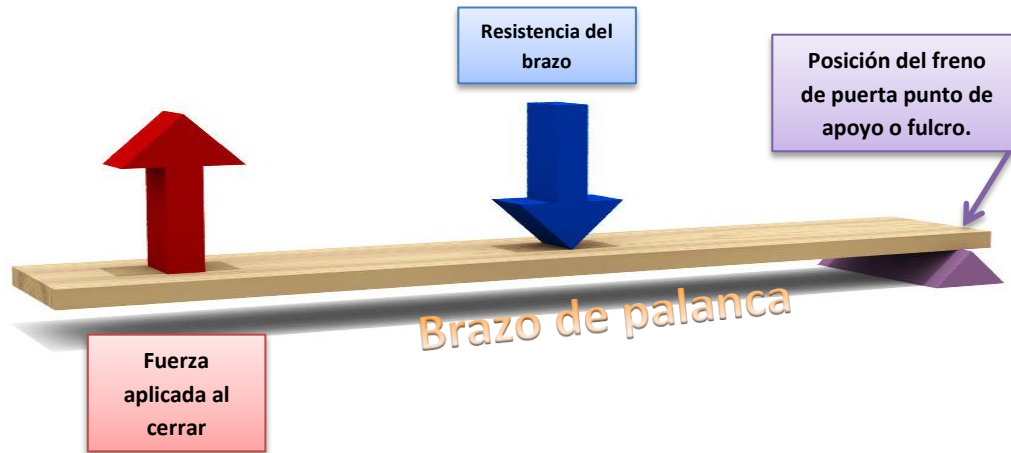
Fig. 6.7 La palanca que compone a la puerta es de segundo grado, es decir, la carga está entre el punto de apoyo y la fuerza.
