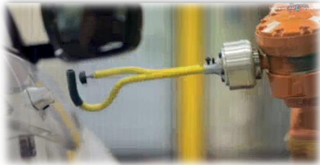
Fig. 5.10 Gripper que simula el movimiento de la mano humana
