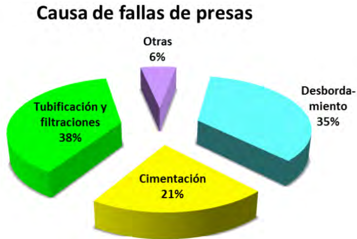
Figura 1.34 Frecuencia de fallas de presas a nivel internacional (Murillo, 2012)
