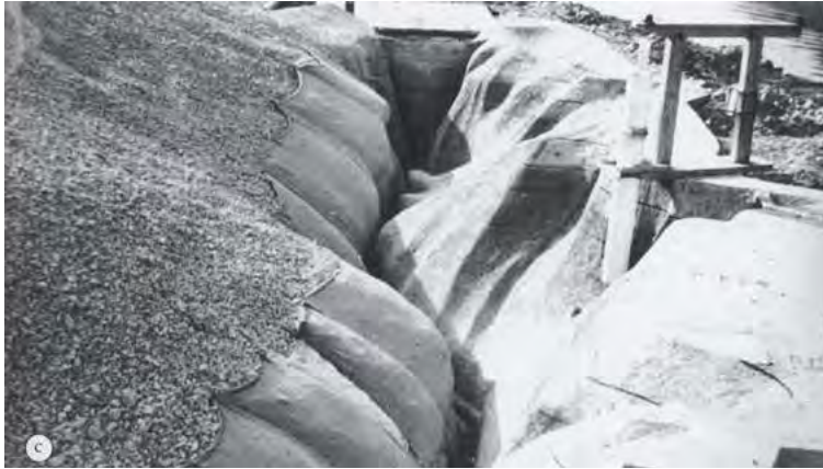
Figura 2.11 Modelo hidráulico de la presa donde se hicieron las pruebas del deslizamiento
