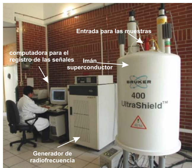
Figura 2.3: Componentes del espectrómetro de RMN empleado en este estudio.
