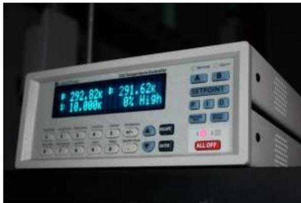
***Fig. 25. Dispositivo de control de temperatura usado para hacer las mediciones de fotoluminiscencia a bajas temperaturas***
