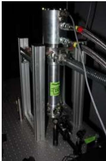
***Fig. 24. Criostato de ciclo cerrado de helio. Se utilizó para hacer los estudios de fotoluminiscencia a bajas temperaturas.***
