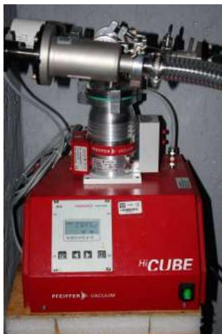
**Fig. 27. Combinación de bomba mecánica y turbo-molecular con la cual se podían alcanzar presiones de hasta  $1 \times 10^{-4}$  mbar.**
