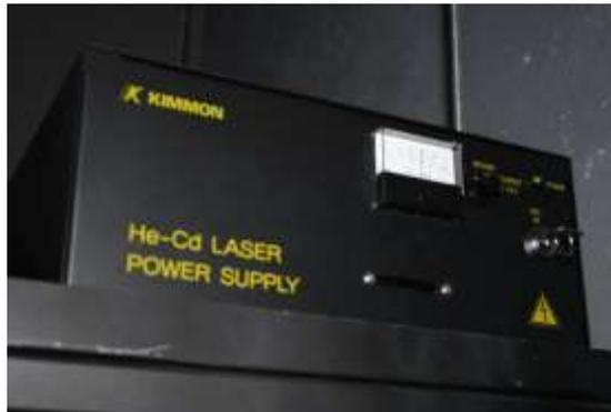
**Fig. 20. Fuente de poder para el láser de helio-cadmio**
