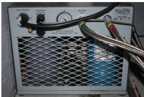
***Fig. 26. Dispositivo utilizado para proveer el helio gaseoso a 10 K.***
