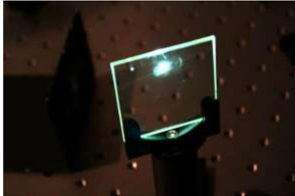
***Fig. 22. Filtro de densidad neutra que se utilizó para hacer las mediciones con variación de potencia láser***
