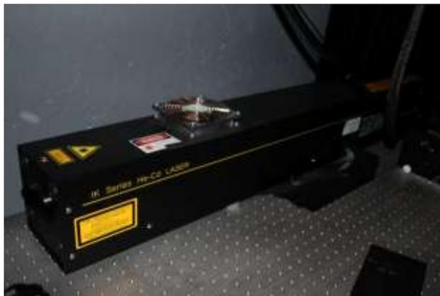
**Fig. 19. Láser de Helio y cadmio que se utilizó para irradiar las muestras y así inducir el fenómeno de fotoluminiscencia**
